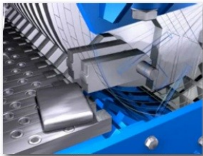
X-Rotor con martillos libres y sensor de golpe
