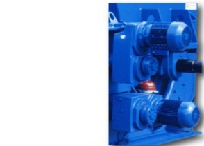
Motores de alimentadores
